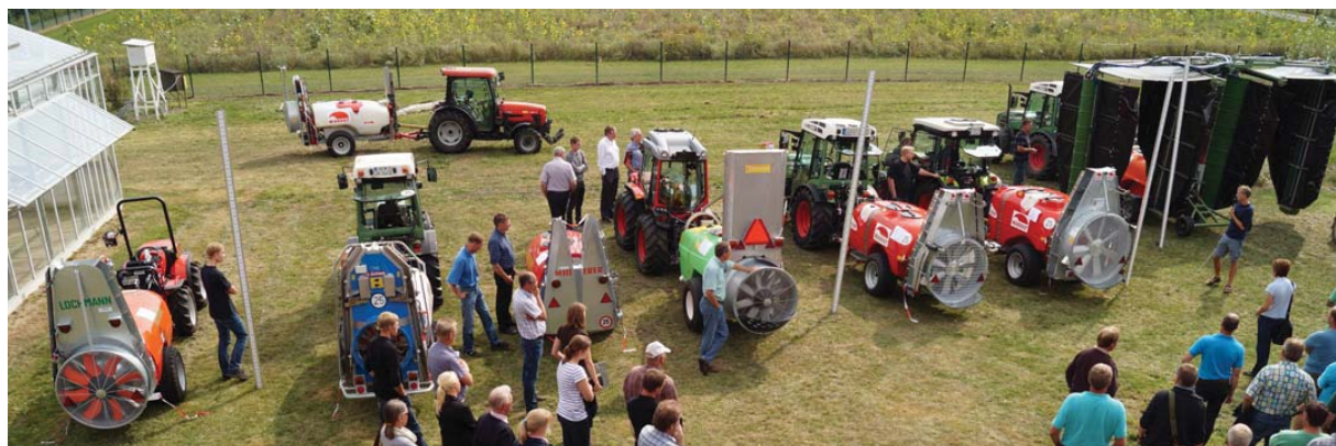
Abb. 2: Moderne Sprühgeräte aus der 90 und 95%-Abdriftklasse (die beiden rechten Geräte sind noch in der Prüfung).
