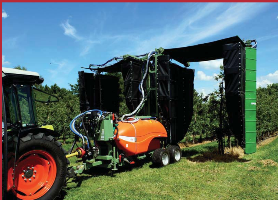
Aktive Abdriftminderung mit Tunnelsprünger
