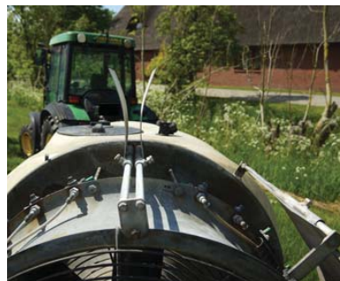
Abb. 1: Um 75% Abdriftminderung zu erreichen, sind neben dem maximalen Gebläsedurchmesser von 920 mm auch Luftstellbleche und eine einseitige Gebläseabdeckung Voraussetzung.
