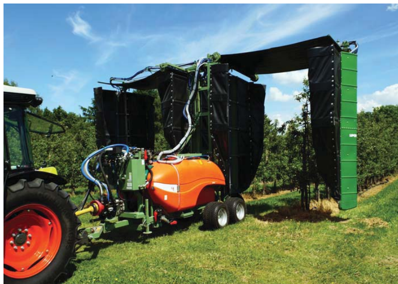
Abb. 4: Zweireihiges Tunnelsprüngerät Typ NVM2.
