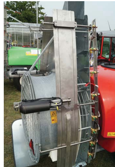
Abb. 3: Beidseitig verschließbare Luftauslässe ermöglichen in der Pufferzone die einseitige Luftabschaltung an beiden Geräteseiten, wie hier am Wanner N36GA zu sehen.
