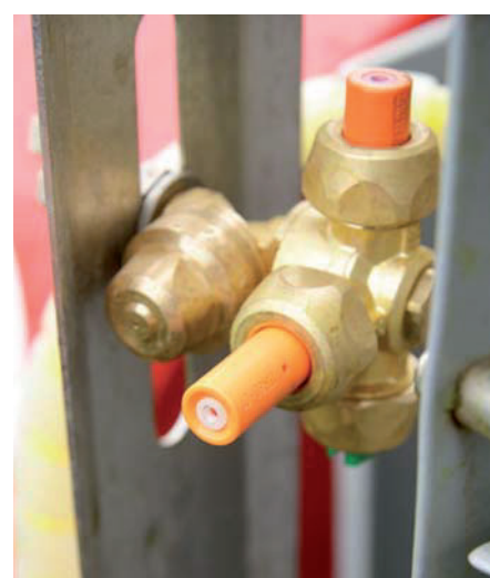
Abb. 1: Die Rundstrahldüse Lechler ITR 80-01 C (vordere Position auf dem Düsenhalter) ist deutlich länger im Vergleich zur Albus TVI 80-01 (obere Position auf dem Düsenhalter).
